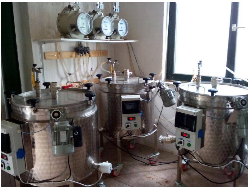
**Obrázok 2** Usporiadanie 100 l fermentorov s plynomermi
