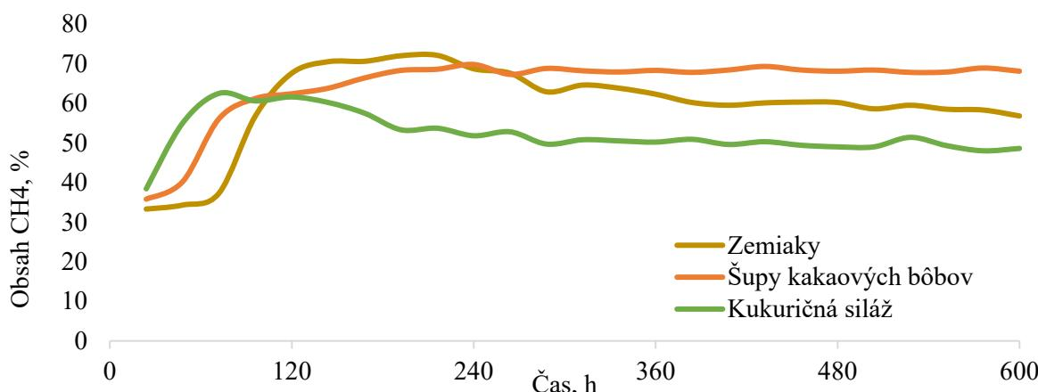
**Obrázok 5** Obsah CH<sub>4</sub> v bioplyne
