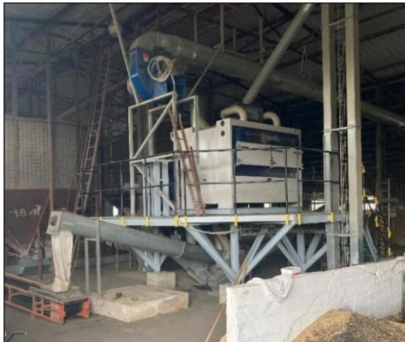
Obrázok 2 Čistička Schneider Jaquet & Cie SNST 1150
