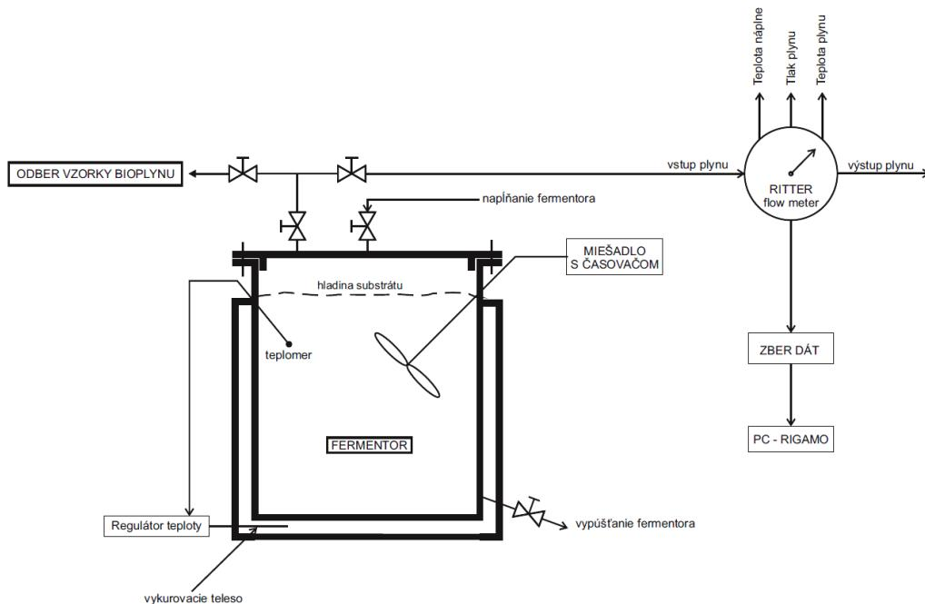
**Obrázok 1** Technologická schéma experimentálneho fermentora 100 l
