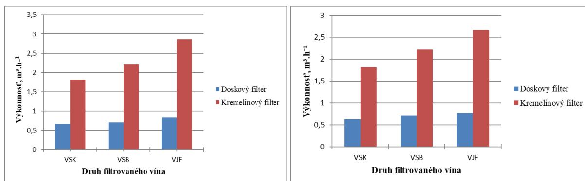
Obrázok 4 Výkonnosť, doskový a kremelinový filter pre tri rôzne stavy filtrovaného vína pre odrody: a) Devín, b) Tramín červený, VSB - víno stočené z bentonitu, VJF - víno jedenkrát filtrované, VSK - víno stočené z kvasenia
