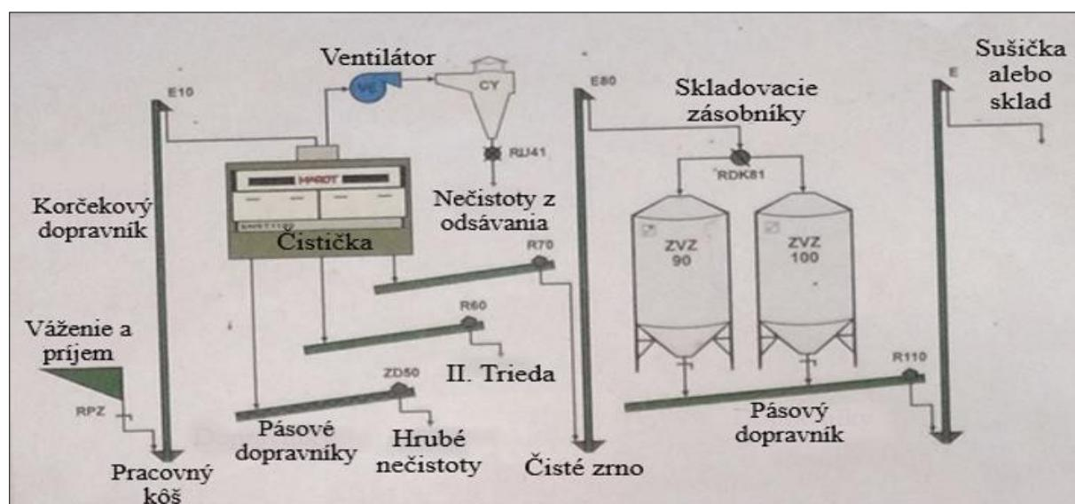
Obrázok 1 Schéma technologickej linky
