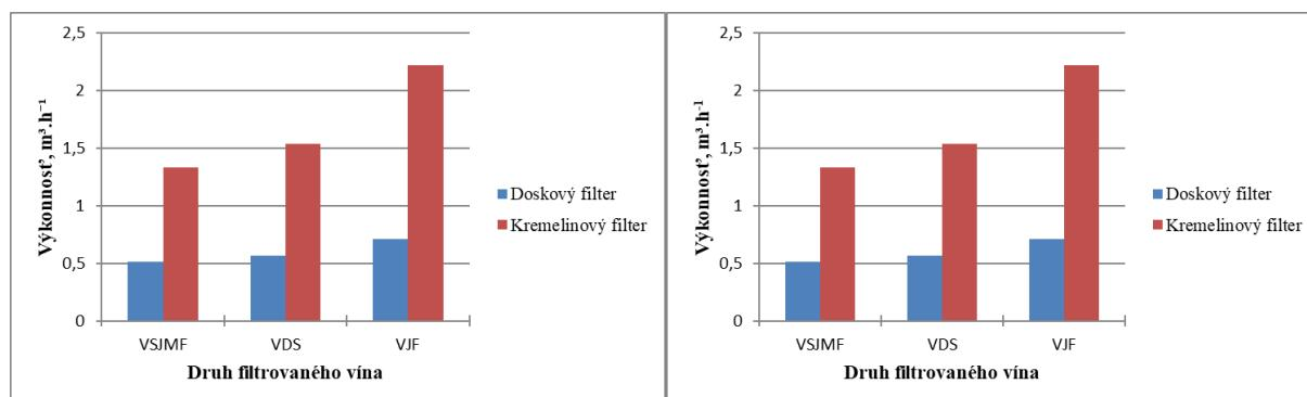
**Obrázok 6** Výkonnosť doskového a kremelinového filteru pre tri rôzne stavby filtrovaného vína pre odrody: a) Dunaj, b) Alibernet , VSB - víno stočené z bentonitu, VJF - víno jedenkrát filtrované, VSK - víno stočené z kvasenia
