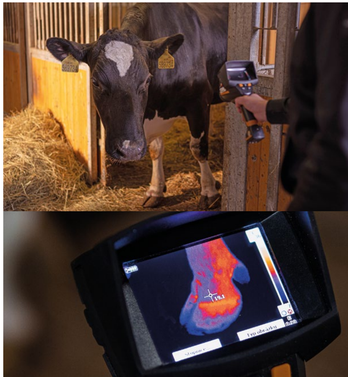
Využitím infračervené termografie lze odhalit onemocnění v počátečním stádiu.
